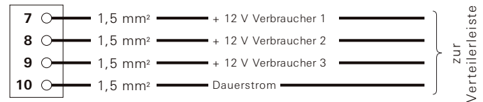
Bild 12: Anschlussplan 4-poliger Steckverbinder
